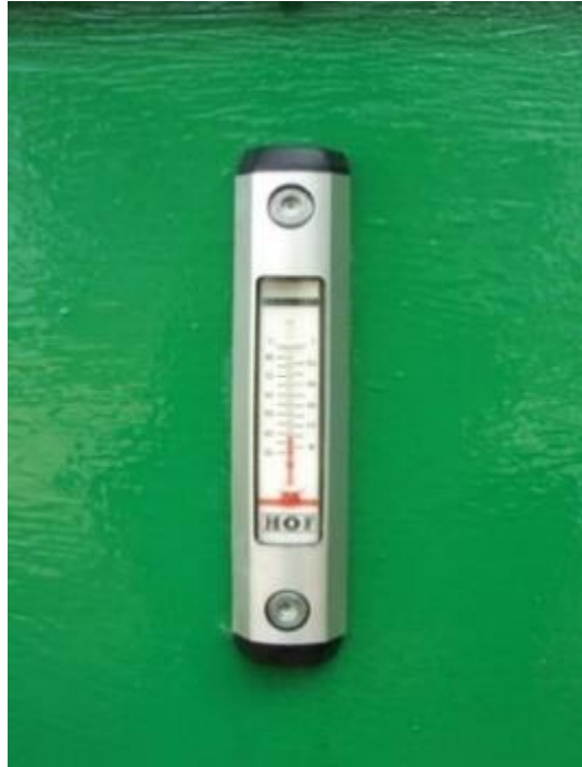
รูปที่ 16 การจัดทำระดับที่ชัดเจน พร้อมใช้น้ำมัน (ที่มา : บริษัท เอ.พี. แมชชีนเนอร์รี่. 2561.
