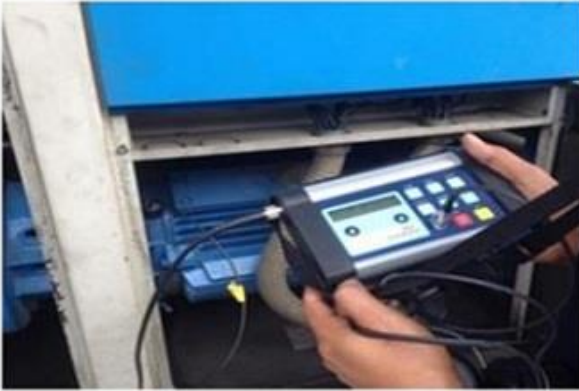
รูปที่ 22 การใช้เครื่องมือตรวจสอบสภาพแบริ่ง (ที่มา : บริษัท อคูสโตเมติก จำกัด. 2561. สืบค้นจาก : www.Acoustomatic.com )
