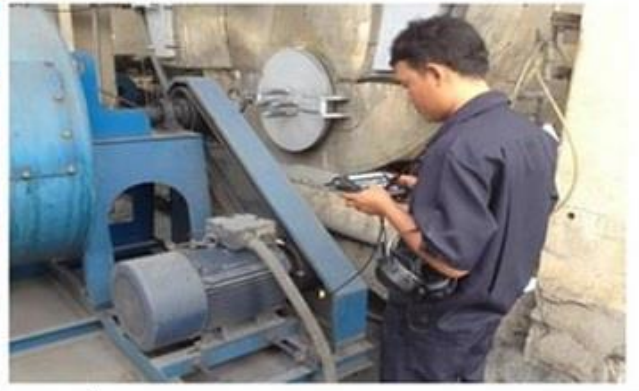
รูปที่ 22 การใช้เครื่องมือตรวจสอบสภาพแบริ่ง (ที่มา : บริษัท อคูสโตเมติก จำกัด. 2561. สืบค้นจาก : www.Acoustomatic.com )
