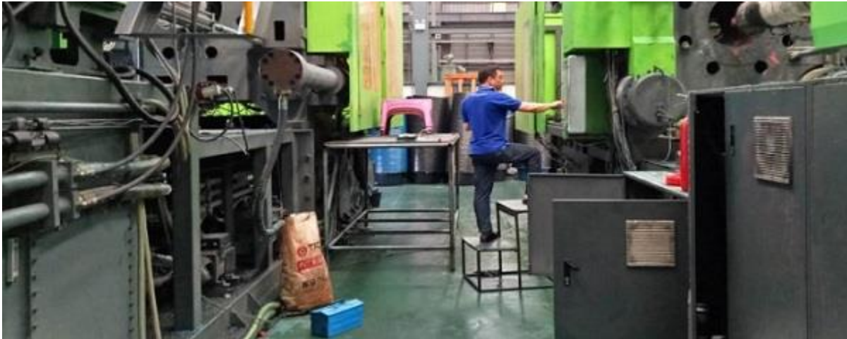
รูปที่ 12 ตรวจสอบสภาพเครื่องจักรด้วยสัมผัส
